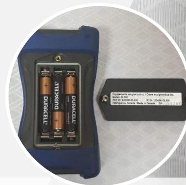
Vue arrière avec piles et couvercle. Étiquette d'identification à l'extérieur du couvercle
